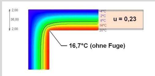
Die Taupunkttemperatur der Raumluft beträgt  $9,3^\circ\text{C}$  ( $20,0^\circ\text{C}$  50%) 80% relative Luftfeuchte werden bei einer Abkühlung der Raumluft auf  $12,6^\circ\text{C}$  erreicht.  $R_{si}/R_{se} = 0,25/0,04 \text{ m}^2\text{K/W}$  /  $\theta_{e} = 20,0 / -5,0^\circ\text{C}$
